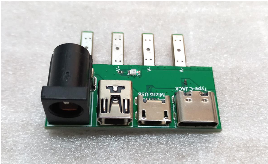
мал. 5 зовнішній вигляд перехідної плати
